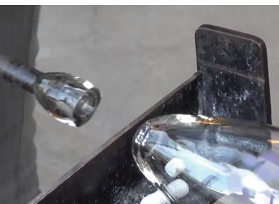
底の部分にガラスをつけた「ポンテ竿」をくっつけます。吹いたガラスが冷めて硬くなってきたら「吹き竿」の先の細く絞った所から切り離します。
