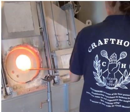
「溶解炉」の中で約1200°Cで溶けているガラスを
