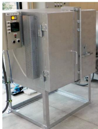
吹きガラスの作業は、約1200°C～600°C位で作業をします。急に室温まで戻すとガラスは割れてしまいます。よって、吹きガラスで作ったガラスは全て、徐冷炉に入れます。工房の作業中の徐冷炉の温度は約500°Cです。工房の全ての作業が終了したら一晩かけて室温まで下げていきます。
